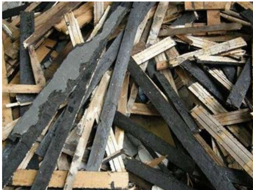
Deski szalunkowe z powłoką bitumiczną lub z przylegającą papą.
